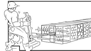
5 DEPOIS DE TER COLOCADO VÁRIAS CAIXAS EM POSIÇÃO, ANTES DE SICHÉ-LAS, PUXE-AS COM UM TIRFOR OU USE GABARITOS DE MADEIRA PARA CONSEGUIR BOM ALINHAMENTO E ACABAMENTO.
