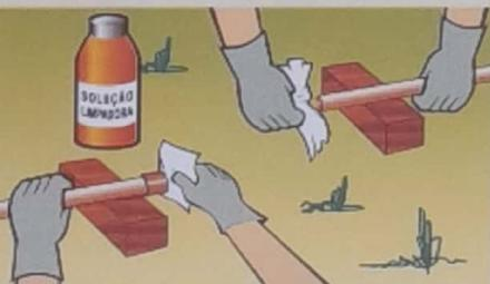
Limpar as superfícies a serem soldadas com flanela branca, embebida na solução limpadora recomendada pelo fabricante.
