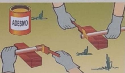
As superfícies limpas devem receber o adesivo especial para PVC rígido, uniformemente distribuído com pincel em camada delgada (fina). Aplicar o adesivo primeiro na bolsa e depois na ponta. Evitar o excesso de adesivo, pois ocorre agressão ao PVC comprometendo a qualidade e durabilidade do mesmo.
