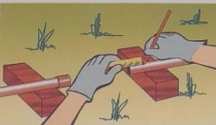
Marcar com lápis na ponta do tubo, o comprimento total da bolsa, para controlar o encaixe perfeito do tubo na bolsa.
