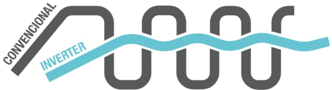
Permite que o ambiente seja **REFRIGERADO DE FORMA CONSTANTE** através da **variação de velocidade do compressor, ao invés de ligar/desligar, como nos modelos convencionais.**
