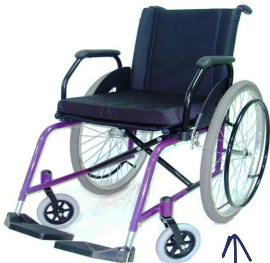
Fabricada em tubos de aço carbono reforçado com assento e encosto em nylon, com opção de almofada removível no assento, dobrável em "X", freios bilaterais zincados, aro impulsor bilateral, apoios para os braços removíveis em poliuretano injetado, apoios para os pés removíveis e com regulagem de altura em nylon injetado, rodas dianteiras aro 6" com pneus maciços, rodas traseiras aro 24" com pneus infláveis e pintura epóxi (eletrostática).
