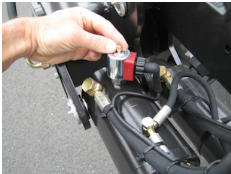
Operação de emergência em todas as eletroválvulas
