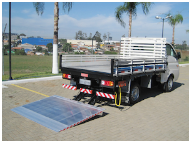
Prato em alumínio com superfície anti derrapante
