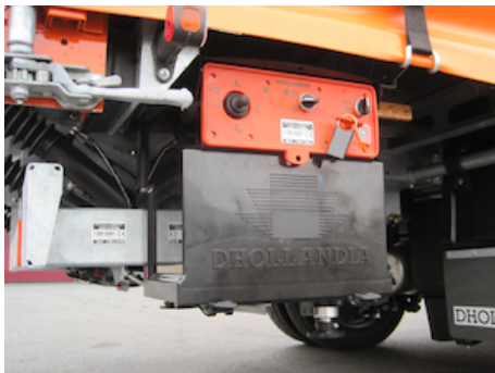
Unidade de comando integrado no grupo hidráulico, com corta corrente e chave removível [OAE039.BP
