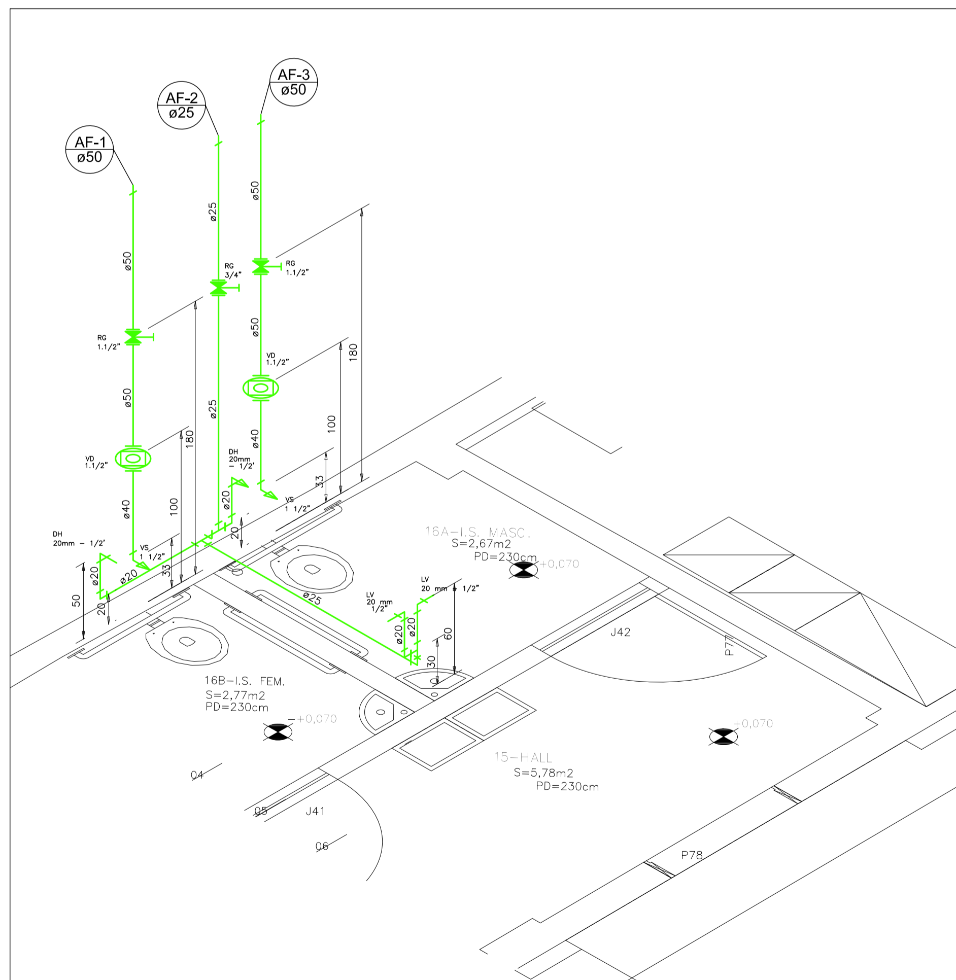
ISOMÉTRICO H3 – I.S. FEM. E MASC. – PAVIMENTO TERREO ESCALA 1:25
